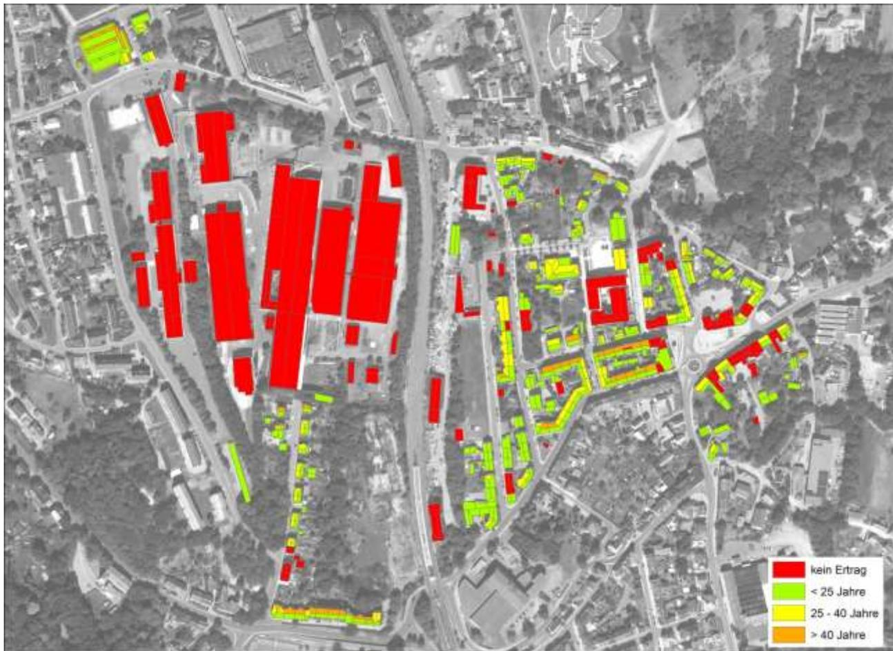
**Abbildung 50 Amortisationsdauer Solarthermie bezogen auf die Dachteilflächen**
