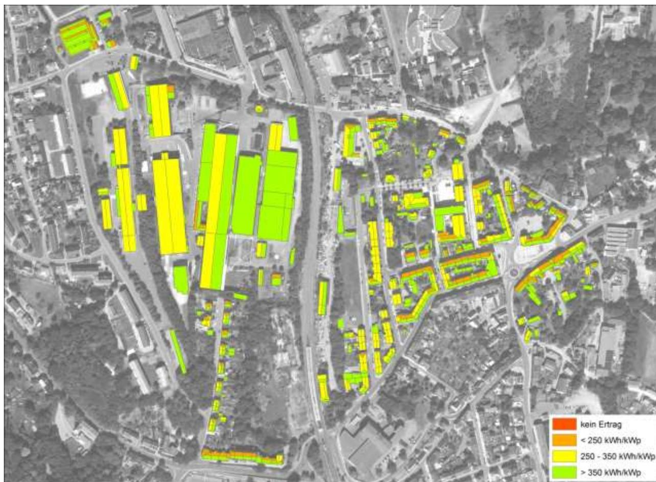
**Abbildung 49 spezifischer Ertrag Solarthermie der Dachteilflächen**
